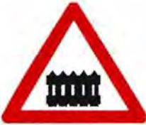
Железнодорожный переезд со шлагбаумом
